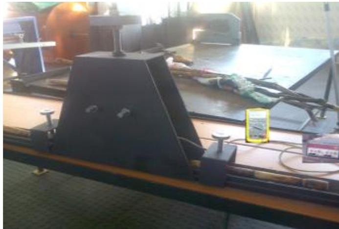
**Figure 1 - Sugarcane moisture detector**
