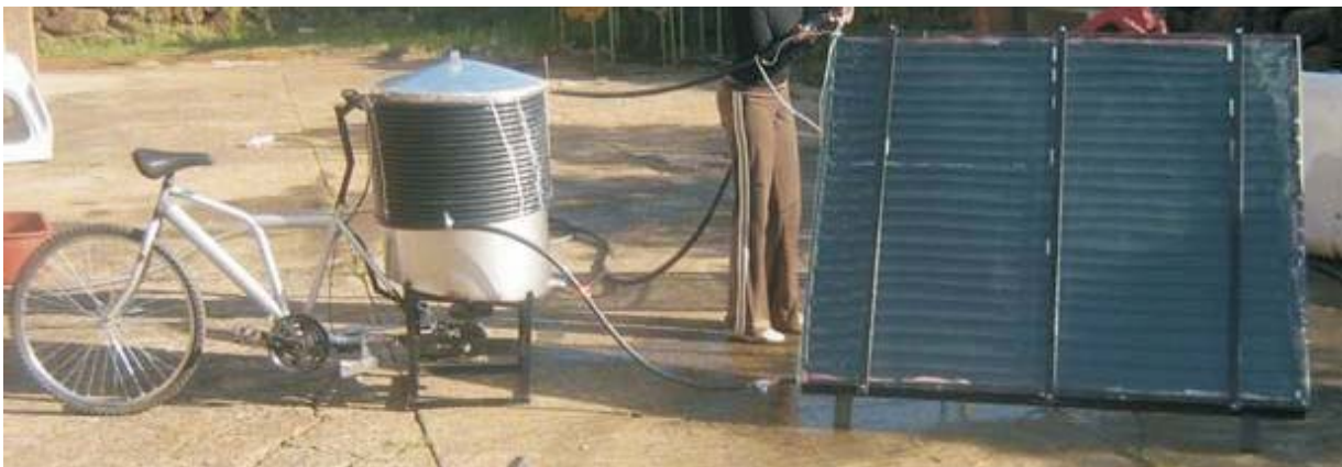
Figuur 9 Hand-aangedrewe heuning-uitswaaier met verhitingsstelsel
