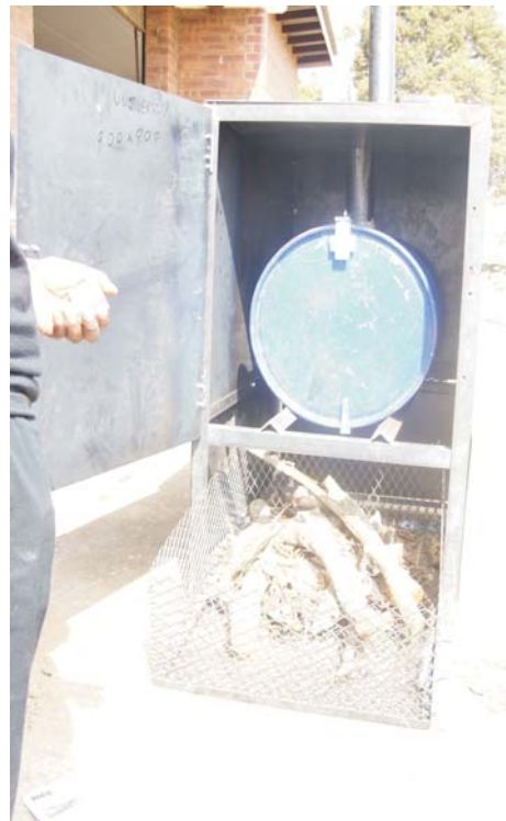
Figuur 7 Pirolise toestel vir houtskool produksie
